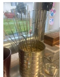
Abb. 15: Metaldorne mit Trennmittel (eigenes Bild)
